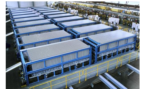
Nel Hydrogen – 20MW Alkaline Electrolyzer
